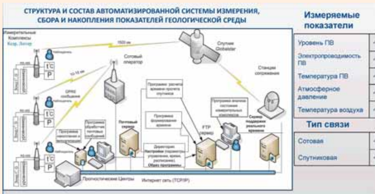
Рис. 5. Автоматизированная система измерения, сбора и накопления параметров подземных вод
