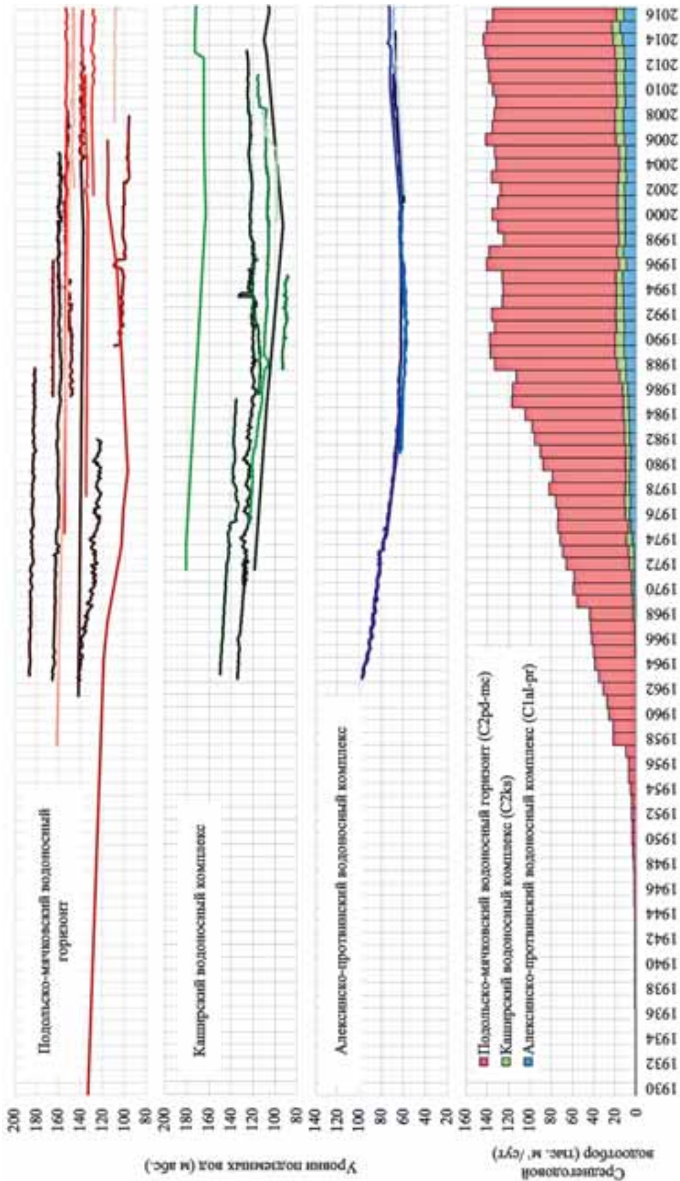
Рис. 3. Ретроспективный график водоотбора и уровней подземных вод каменноугольных горизонтов в Новой Москве
