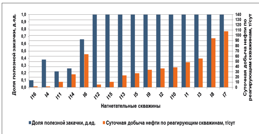
Рис. 41. Пример построения рейтинга эффективности работы нагнетательного фонда на одном из активов Компании. Синие столбцы – доля полезной закачки, оранжевые столбцы – суточная добыча нефти за счет работы нагнетательной скважины
